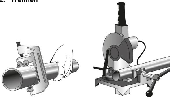
Die systemkonformen Rohre können mit handelsüblichen Trennwerkzeugen, die für metallische Werkstoffe geeignet sind, abgelängt werden.
