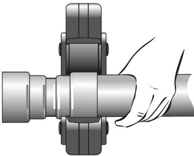
Sorgen Sie vor dem Pressen dafür, dass der Pressverbinder richtig positioniert ist. Nach dem Pressen kann dieser nicht mehr bewegt oder verdreht werden. Die Presszange (Pressbacke) mit dem richtigen Durchmesser und der jeweils geeigneten Presskontur auf die jeweilige systemkonforme Positionierung setzen und den Pressvorgang starten.
