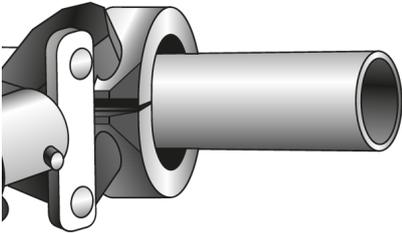
Nun den Presszyklus ablaufen lassen und darauf achten, dass die Pressschlinge/-kette komplett geschlossen wird.
