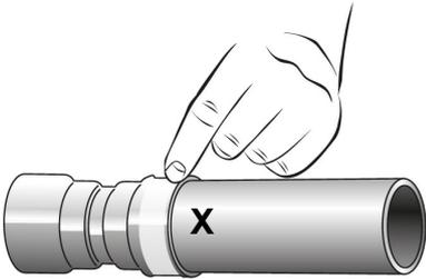
Nach dem ordnungsgemäßen Ablauf des Presszyklus ist der Pressverbinder komplett gepresst. Die systemkonforme Presskontur ist deutlich zu sehen.
