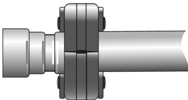
Nun den Presszyklus ablaufen lassen und darauf achten, dass die Presszange (Pressbacke) komplett geschlossen wird.
