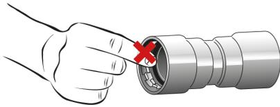
Vor dem Einführen des Rohrabschnittes in die Pressmuffe des Formteiles ist es erforderlich das Dichtelement auf richtigen Sitz, eventuell Verletzung bzw. Verschmutzung visuell zu überprüfen.
