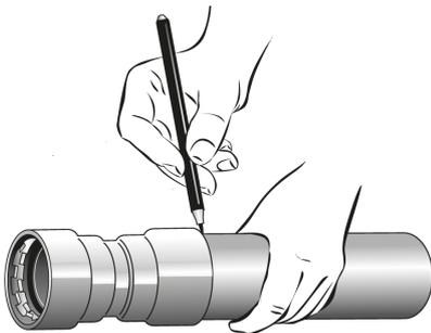
Eine dauerhafte Markierung auf dem systemkonformen Rohr bzw. der Formteile mit Einsteckenden, wie z. B. Bogen a/i, Passbogen a/i dient der Erreichung der erforderlichen mechanischen Festigkeit der Pressverbindung. Diese Markierung ist vor dem Pressen auf der Einsteckseite das Rohres an-/aufzubringen.
