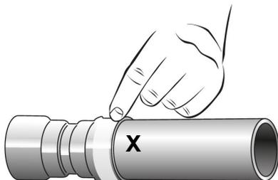
Nach dem ordnungsgemäßen Ablauf des Presszyklus ist der Pressverbinder komplett gepresst. Die systemkonforme Presskontur ist deutlich zu sehen.
