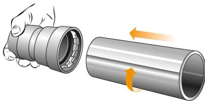
Danach wird der Rohrabschnitt unter leichtem Druck und Drehen bis zum Anschlag in den Pressverbinder geschoben.
