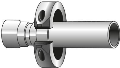
Sorgen sie vor dem Pressen dafür, dass der Pressverbinder richtig positioniert ist. Nach dem Pressen kann dieser nicht mehr bewegt oder verdreht werden. Die Pressschlinge/-kette mit dem richtigen Durchmesser und der jeweils geeigneten Presskontur auf die jeweilige systemkonforme Positionierung setzen und den Pressvorgang starten.
