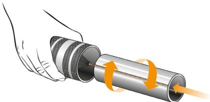
Nach dem Trennvorgang der systemkonformen Rohre müssen die Rohrenden innen wie außen mit einem geeigneten Rohrentgrater oder einer geeigneten Handfeile für Stahlrohre bearbeitet werden.
